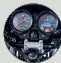
Medidor de combustible y testigo de pata
