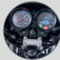
Medidor de combustible y testigo de pata
